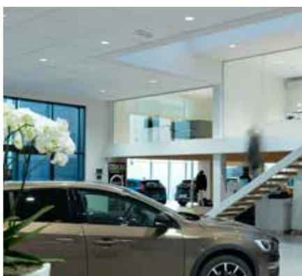
Der Kunde wollte ausdrücklich keine Hängeleuchten in diesem Bereich, um auch bei wechselnder Büroanordnung ein perfektes Lichtschema zu erhalten. Daher wurden in diesen Bereich "Insaver LED II" Downlights in die Rigips-Decken integriert.
